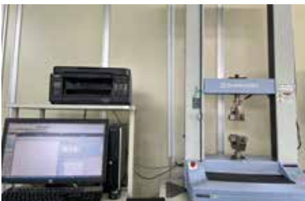
本社試験室に設置したデジタル式引張試験機
