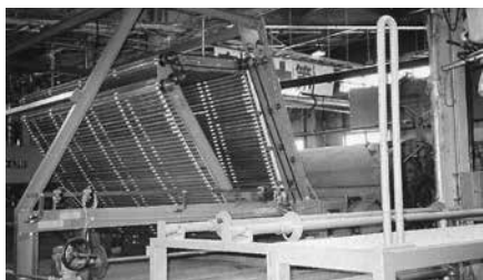
北海道工場に設置した河川護岸吸い出し防止シート（ステラフェルト）の製造機
