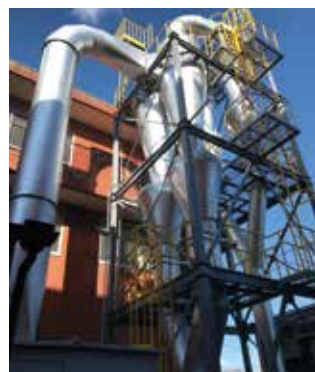
II ASライン集塵機に取り付けられた防音装置
