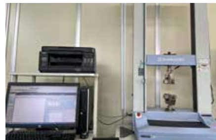
本社試験室に設置したデジタル式引張試験機
